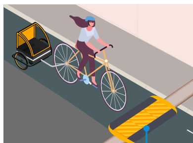
Franchissement tranchée : Plaque sans ressaut (< 2 cm)
